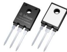
新しいパッケージコンセプトは、性能、設計の柔軟性、扱いやすさの観点での高い要求に応えるものです。放熱グリスや放熱インターフェースシートなどが不要な TRENCHSTOP™ Advanced Isolation パッケージは、熱抵抗を 35%以上、システムコストを 10%以上低減しました。また、システムの複雑さをなくし、開発時間、組み立て時間の短縮が可能になりました。
