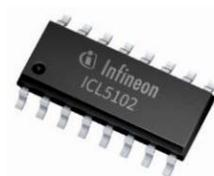
ICL5102は、力率改善コントローラ (PFC) およびハーフブリッジコントローラ (HBC) を搭載した、電源、照明ドライバに特化した共振コントローラICです。70 VACから325 VACのユニバーサル入力電圧に対応し、広い出力範囲を持ちます。本IC用に設定しなければならない外部部品数が少なく済み、全パラメータはレジスタで設定します。ICL5102は、100  $\mu$ A未満の消費電力、500ms未満の高速起動時間を実現しています。99%以上のクラス最高の力率改善 (PFC) に、3.5%未満の全高調波歪 (THD) を誇ります。共振技術により最大94%の高効率を提供します。有効/無効切替機能付き、300mW未満の低スタンバイ用アクティブバーストモードによりLED調光に対応。
