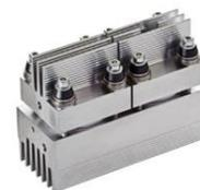
Infineon Technologies Bipolar は、新しいソフトスタータモジュールを搭載することにより、ソフトスタートアプリケーション用の完全なラインアップをお客様に提供します。既存のソフトスタータソリューションと比較した際の、新しい設計コンセプトの主な利点は、1つのスリムなフットプリント（55 mm）で、すべての電流クラスに使用できるため、コンタクト互換設計（LxWxH 134x55 x100 mm）が可能という点です。インフィニオン®パワースタートモジュールは、ヒートシンク内蔵のため、放熱グリスなしで取り付けすることができます。
