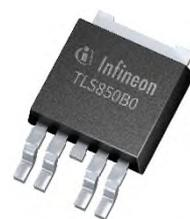
車載用低暗電流リニア電圧レギュレータファミリー-TLS850B0xx は、TO263-5 および TO252-5 パッケージ、3.3V~5.0V 電源の高性能な超低ドロップアウト・リニア電圧レギュレータです。3.0V~40V の入力電圧範囲および 20  $\mu$ A の非常に低い暗電流は、恒久的にバッテリー接続される車載などの電源システムに最適です。
