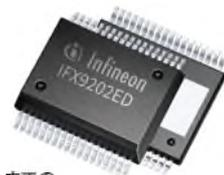
IFX9202ED は、産業用アプリケーション、家電、ビルオートメーション、電動工具のバッテリー管理、医療アプリケーション向けの汎用 6A デュアルハーフブリッジドライバです。小型 DC モータおよび誘導負荷の制御用に設計されています。PWM/DIR 制御により、人間の可聴域を超えた 20kHz までの周波数で、出力をパルス幅変調することができます。方向入力信号が DC モータの方向を定義している間、PWM 信号はデューティ・サイクルを制御します。負荷電流が電流制限しきい値 (8A typ.) を超えると、H ブリッジはチョッパ電流制限モードに切り替わります。IFX9202ED は、短絡保護、加熱保護機能を搭載し、SPI 経由での診断機能、またステータスフラグによるベーシックエラーのフィードバックを提供します。ブリッジ無効時もしくは誘導負荷の PWM 動作中に、オープン負荷が検出できます。堅牢な PG-DSO-36-72 パッケージは、優れた放熱性を提供します。
