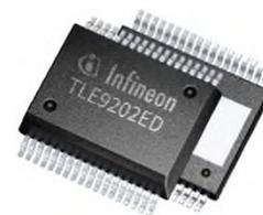
TLE9202ED は、独立した 2 個の汎用 6A ハーフブリッジをワンパッケージ化した製品です。本製品は、車載アプリケーションにおける DC モータまた誘導負荷などの制御用に開発されました。出力は最大 20kHz でパルス幅変調が可能です。PWM/DIR 制御により、マイコン側で必要な PWM 対応ピン数を削減できます。負荷電流が電流制限しきい値を上回ると、チョッパ電流制限モードに切り替わります。本製品は、短絡保護、過熱保護を備え、SPI 診断および簡易エラーログにより詳細な診断を出力します。ブリッジ無効時もしくは誘導負荷の PWM 動作中に、オープン負荷が検出できます。
