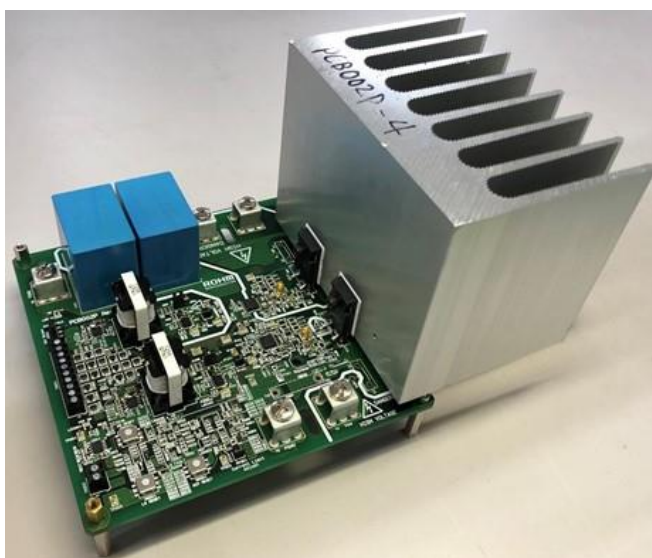
Figure 21. ヒートシンク取り付け例
